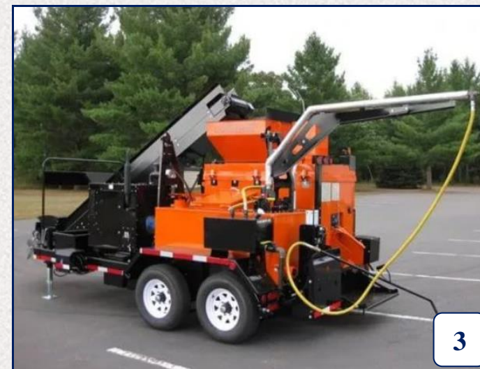
Машины для разогрева гранулята: 1 - кохер; 2 - рециклер EM-3200; 3 - рециклер SRM
