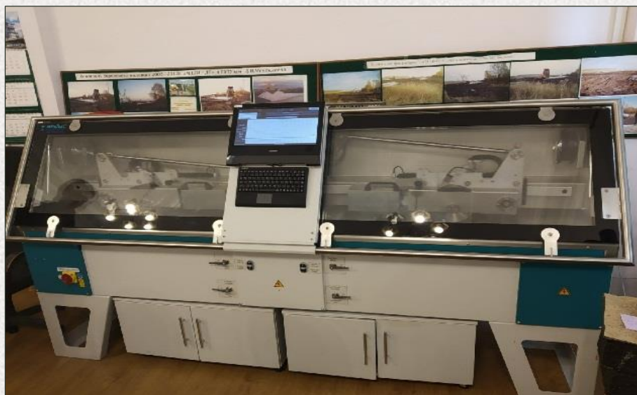
Установка для проведения испытаний на колееобразование (кат. 20-4000)
