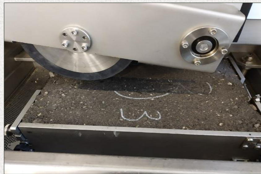
Установка для проведения испытаний на колееобразование (кат. 20-4000)
