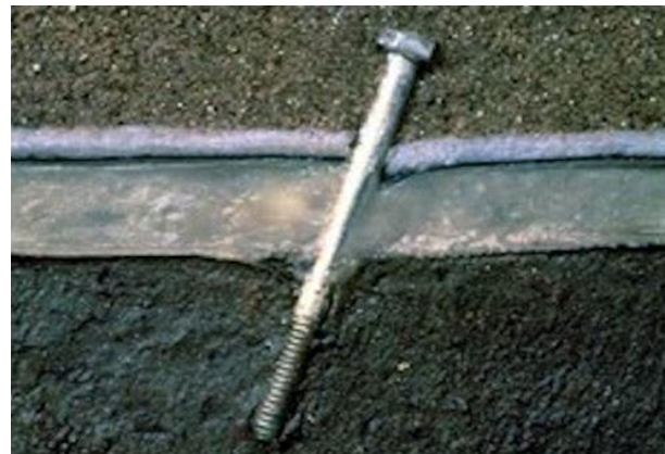
Бентонитовый мат восстанавливает свои гидроизоляционные свойства при проколах, благодаря увеличению объема и пластичности бентонитовой глины
