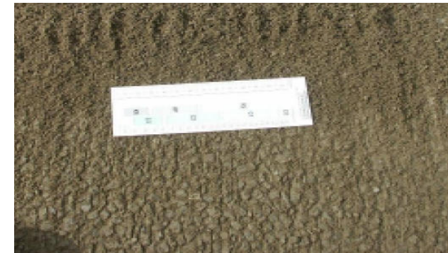
Определение момента для обнажения заполнителя
