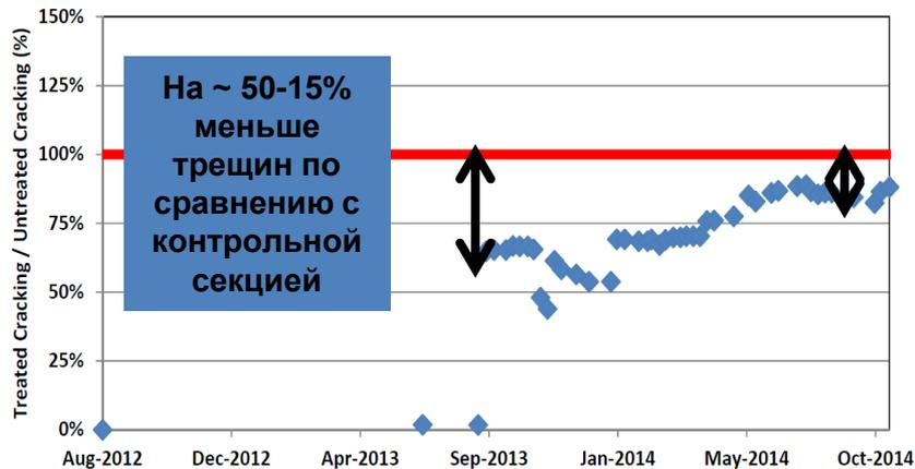
Сларри-сил без предварительного ремонта трещин
