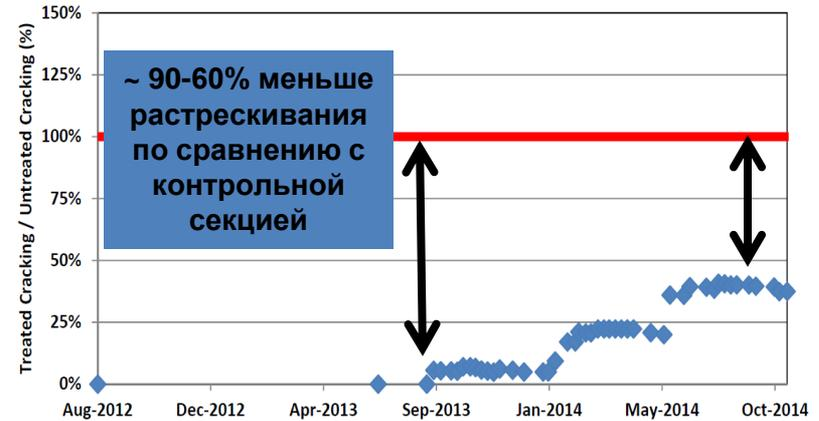
Сларри-сил + предварительный ремонт трещин
