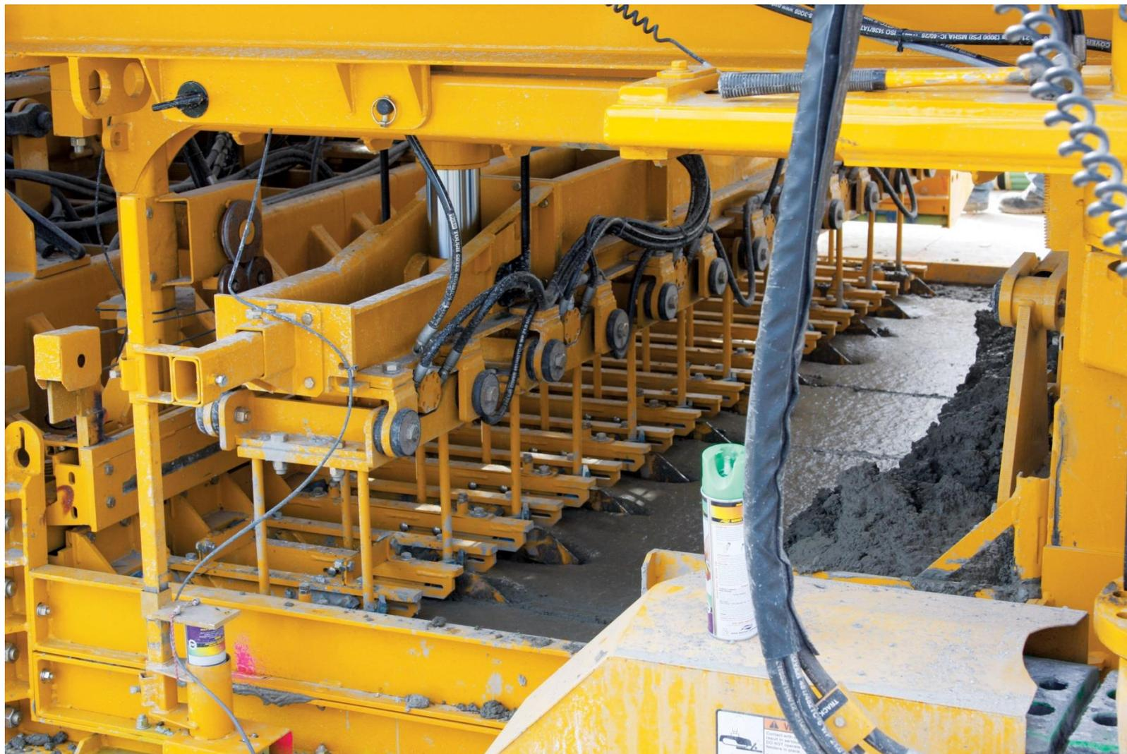
**Обеспечение точного погружения стержня и качественного уплотнения смеси вокруг них – преимущество системы GOMACO IDVI.**
