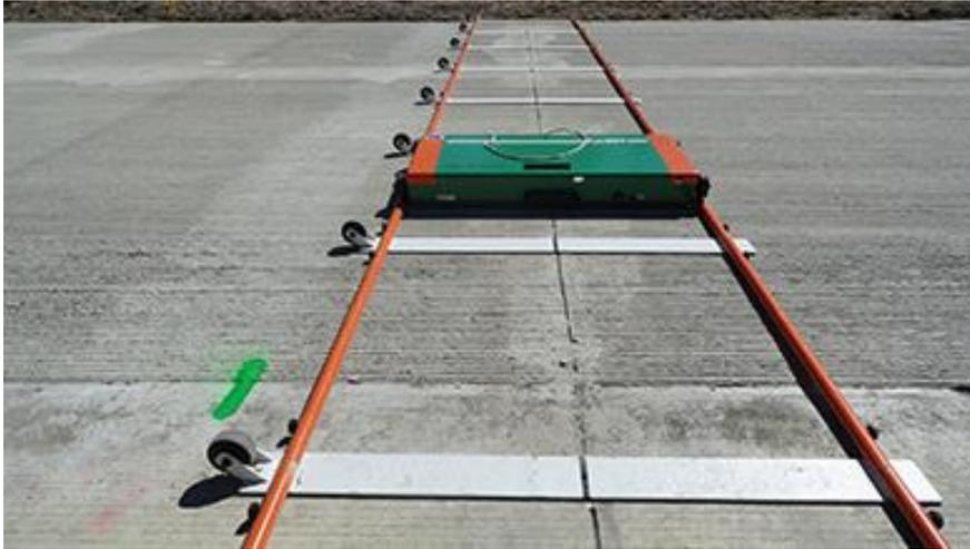
Прибор определяет наличие стальной арматуры на всю глубину покрытия
