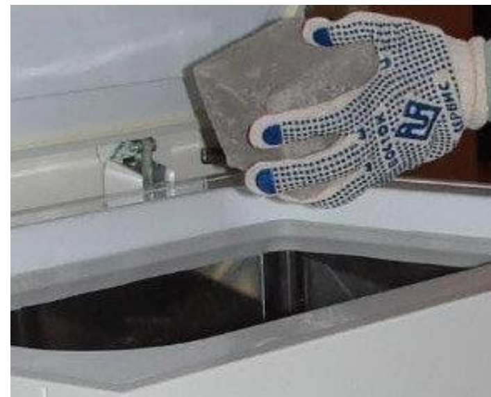
Испытание на морозостойкость в растворе хлорида в емкостях
