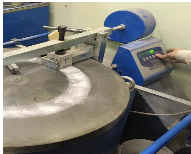
Испытание на истираемость на круге Беме
