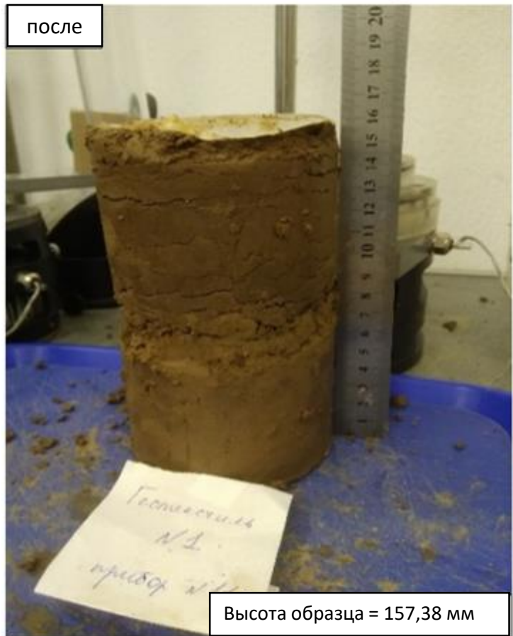
Образцы мерзлого грунта, демонстрирующие морозное пучение без геокомпозита и с ним (5 см)
