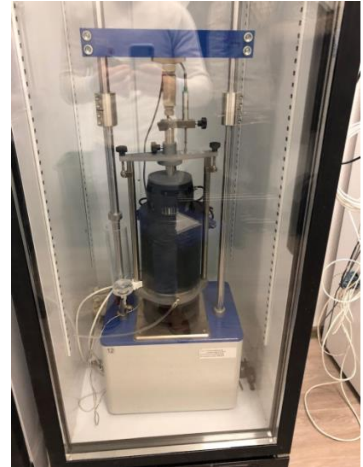
Устройство для испытания согласно ГОСТ 28622-2012
