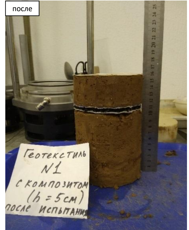
Образцы мерзлого грунта, демонстрирующие морозное пучение без геокомпозита и с ним (5 см)
