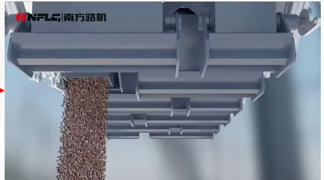
2. Большой затвор закрывается, маленький затвор додозирует материал
