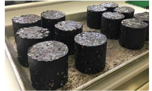
асфальтобетон, модифицированный резиновой крошкой
